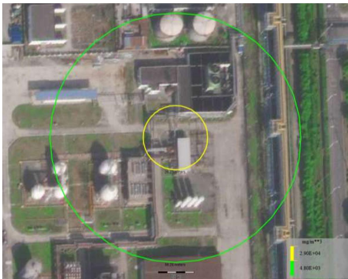
图 7.1-1 丙烯管道泄漏扩散影响示意图（最不利气象条件）
