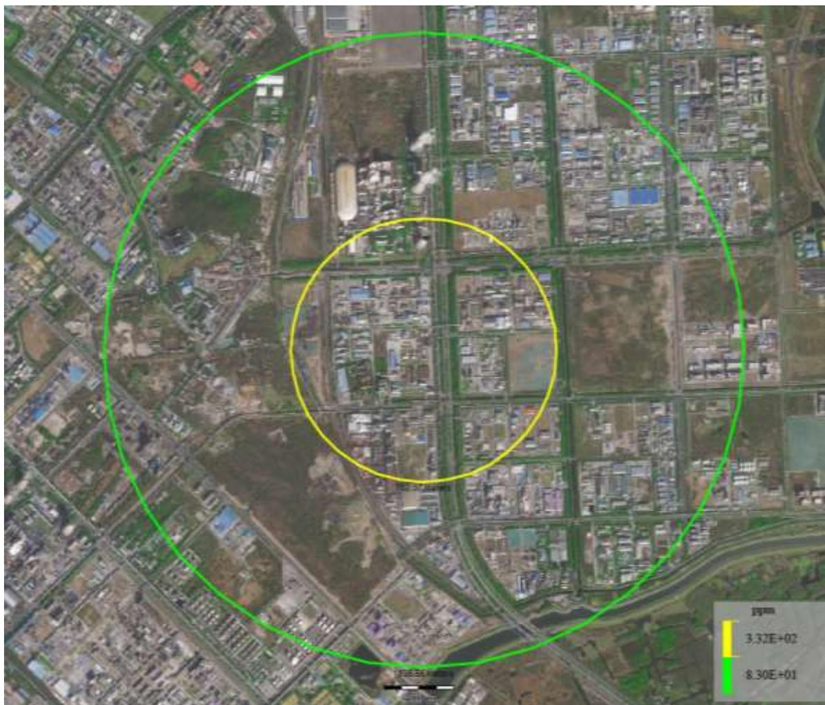
图 7.1-2 丙烯管道泄漏后火灾次半生 CO 扩散影响示意图（最不利气象条件）
